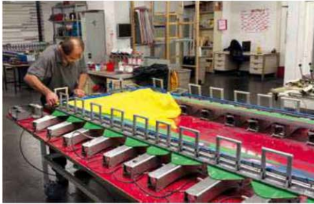
Bei Siebdruckservice Süd sind drei pneumatische und drei mechanische Spanngeräte im Einsatz.
